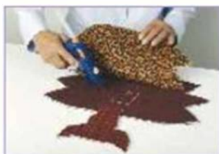
Рис. 6.13. Производство многослойной ткани методом склеивания
