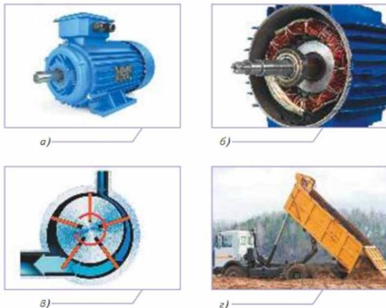
Рис. 4.7. Вторичные двигатели: а — электромотор; б — электродвигатель; в — пневматический двигатель; г — гидравлический подъёмник (двигатель) кузова автомобиля
