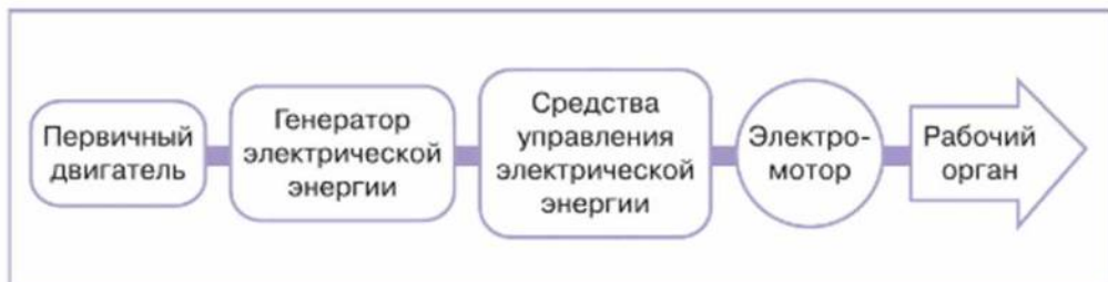
Рис. 4.14. Схема электрической передачи
