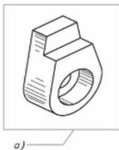
Рис. 3.4. Конструкторская документация: а — технический рисунок; б — чертёж; в — эскиз; г — электрическая схема; д — пневматическая схема
