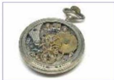
Рис. 4.8. Передаточный механизм в часах
